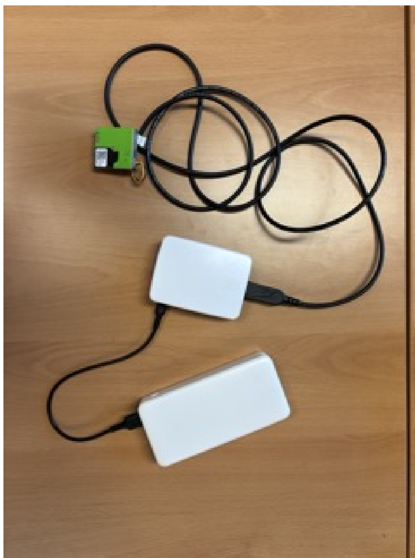
FIGURE II.9 – Dispositif comprenant un Raspberry Pi, une batterie et un capteur de micro-particules SPS30
